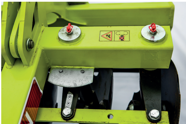
Рис. 16 - Регулирование глубины обработки почвы на бороне дисковой SOIL 3,2
