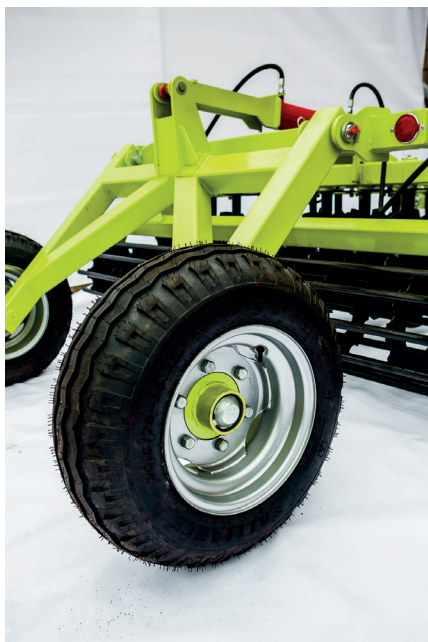
Рис. 13 - Шток гидроцилиндра полностью открыт, упор в рабочем положении.
