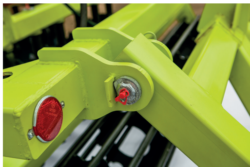
Рис. 12 - Крепление крыла к раме
