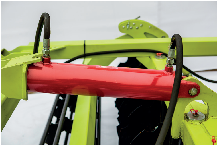
Рис. 13 - Шток гидроцилиндра полностью открыт, упор в рабочем положении.
