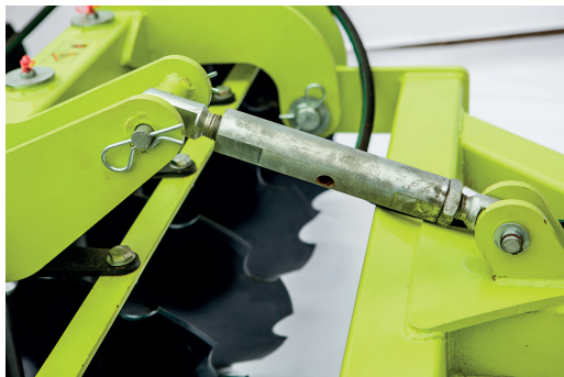
Рис. 10 - Фиксация рабочих органов бороны в рабочем положении
