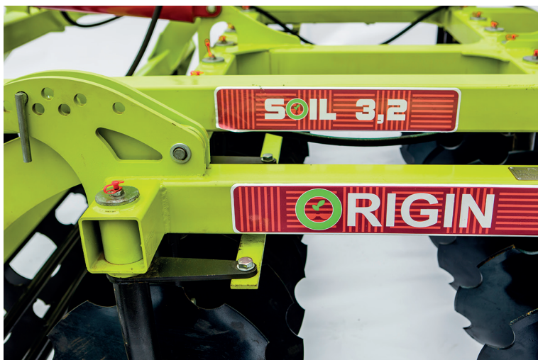
Рис. 17 - Регулирование глубины обработки почвы на бороне дисковой SOIL 3,2-01»
