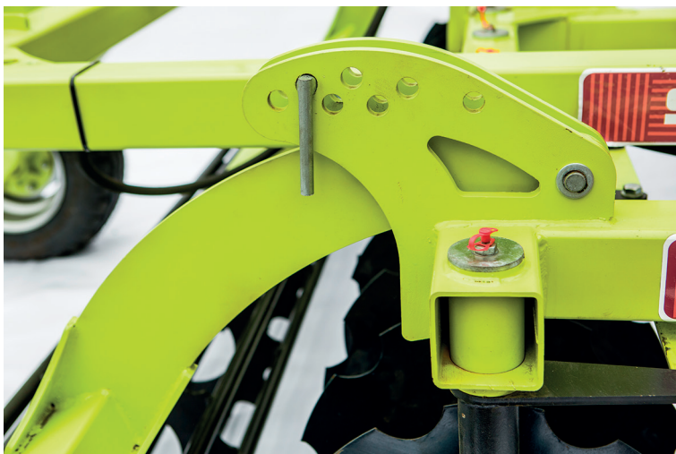
Рис. 18 - Соответствие расположения отверстий в кронштейнах относительно глубины обработки почвы на бороне дисковой SOIL 3,2-01
