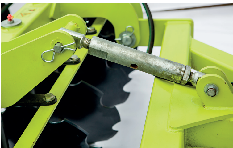
Рис. 19 - Изменение угла атаки
